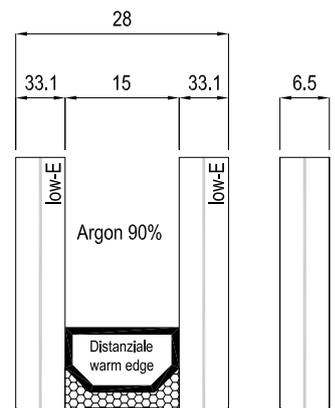
Trasmittanza termica della finestra  $U_w=1,0$  W/(m<sup>2</sup>K)
