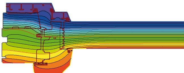
Nel sistema uni\_one Termoscudo, vengono inseriti fra il legno e l'alluminio, un telaio ed un anta in XPS che permettono di raggiungere valori di trasmittanza termica estremamente bassi.
