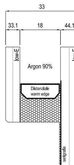
Trasmittanza termica della finestra  $U_w=1,2$  W/(m<sup>2</sup>K)
