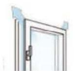
Un quarto di giro della maniglia permette di distanziare le guarnizioni isolanti di 6 mm per una **microventilazione** costante senza raffreddare la stanza e senza compromettere la **sicurezza**.
