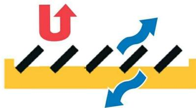
**Aerazione:** l'inclinazione di *Waterproof Evolution*, da 0° a 140°, impedisce al calore di entrare e garantisce una costante aerazione.
